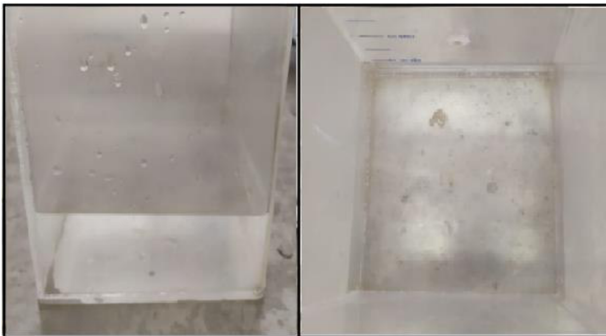
Figura 22 - Amostra após tratamento integrado ABC e filtração em leito de argila expandida e carvão ativado
