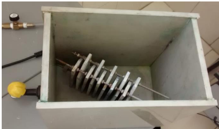
Figura 6 – Reator eletrolítico de bancada utilizado nos experimentos eletrolíticos (A)
