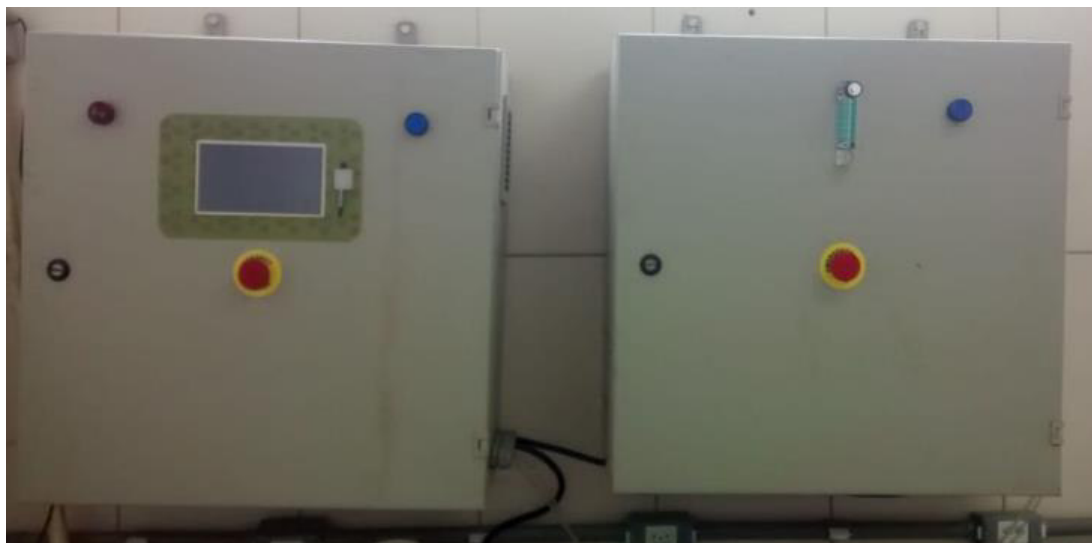
Figura 8 - Gerador de ozônio com vazão de 10L/min utilizado nos experimentos de ozonização (C)
