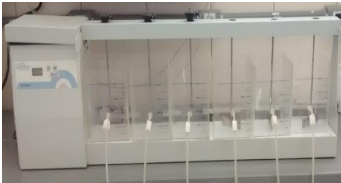
Figura 7 – Equipamento de Jar Test (Teste de jarro) utilizado na realização dos experimentos físico-químicos (B)
