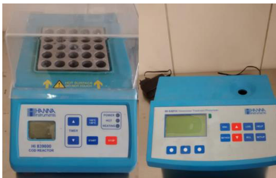
Figura 4 – Conjunto reator HI839800/Fotômetro HI83124 utilizado para a realização das análises de DQO
