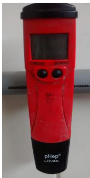
Figura 2 – pHmetro HI98128 utilizado para a caracterização do pH das amostras
