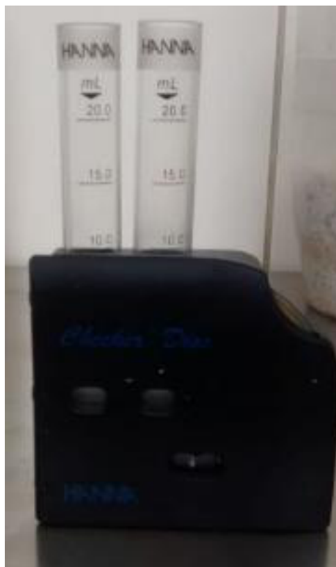
Figura 5 – Kit para teste de fenol HI3864 utilizado para a realização das análises de fenol
