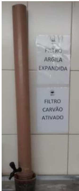
Figura 9 - Filtro de argila expandida e carvão ativado utilizado no processo de pós-tratamento proposto
