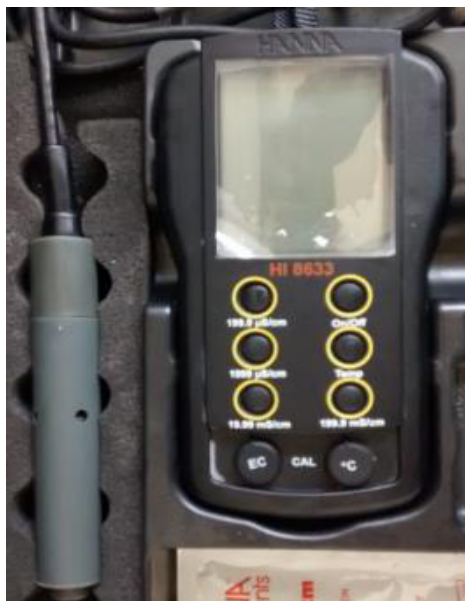
Figura 3 – Condutivímetro HI8633 utilizado para a caracterização da condutividade nas amostras
